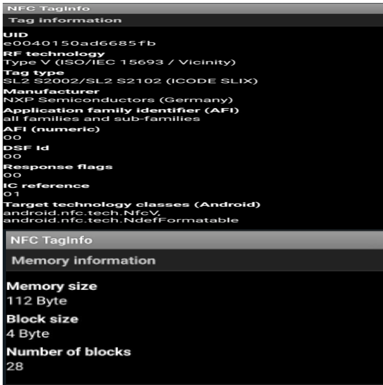
Fig 1. Información del CHIP RFID Boleta de votación.
