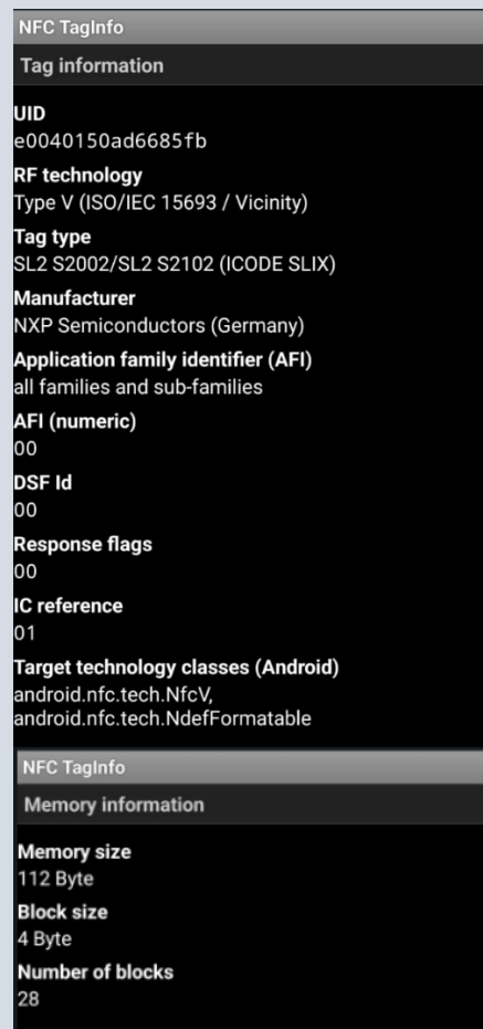
Fig 1. Información del CHIP RFID Boleta de votación.
